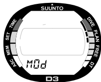
Fig. 3.15. El ajuste de la Profundidad Máxima de Uso se muestra con la indicación MOD y los indicadores de modo.
