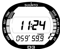
Fig. 2.9. La cuenta atrás comienza a partir del tiempo preprogramado, y el indicador DT parpadea.
