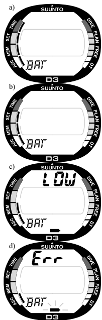
Fig. 3.4 Puesta en marcha II. Indicador del nivel de carga de la pila.
