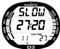
Fig. 3.20. Indicador de Velocidad de Ascenso. La indicación SLOW parpadea, se visualizan 4 segmentos y se dispara la alarma sonora. La velocidad de ascenso es superior a 10 m/min. [33 pies/min.].
