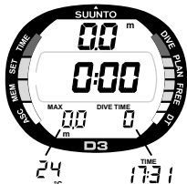
Fig. 3.5. Puesta en marcha III. Modo Buceo. La profundidad y el tiempo de inmersión están a cero. Presionando los botones +/- se visualizan alternativamente en la pantalla la profundidad máxima y el tiempo real.
