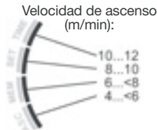
Fig. 3.19. Indicador de Velocidad de Ascenso. Los segmentos indican la velocidad de ascenso.
