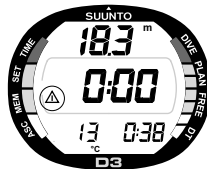
Fig. 3.8. Activación del marcador. Durante la inmersión, se puede señalar una anotación o un marcador en la memoria del perfil de inmersión, pulsando el botón S . (se visualiza el símbolo de marcador).
