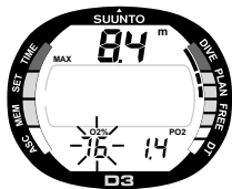
Fig. 3.16 El modo Buceo muestra la Profundidad Máxima y los valores correspondientes de % de O_2 y PO_2 .
