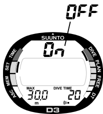
Fig. 4.15. Pantalla de Alarma del Tiempo de Inmersión. La visualización muestra un tiempo de inmersión de más de 5 minutos.
