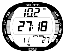
Fig. 3.18. Visualización durante la inmersión. La profundidad real es de 10,2 m, el tiempo de inmersión es de 27 minutos y 18 segundos, y la temperatura y el tiempo de inmersión aparecen en la parte inferior de la pantalla.
