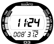
Fig. 2.7. El cronómetro muestra en pantalla las horas, los minutos y los segundos.
