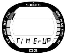
Fig. 2.6. La función Cronómetro se señala con la indicación TIMER UP y un indicador de tiempo.
