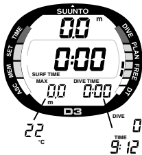
Fig. 3.10. Visualización en Superficie / visualizaciones alternativas.
