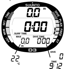
Fig. 3.6. Puesta en marcha IV. Modo Free (Apnea). La profundidad y el tiempo de inmersión están a cero. Presionando los botones +/- se visualizan alternativamente en la pantalla la profundidad máxima y el tiempo real.
