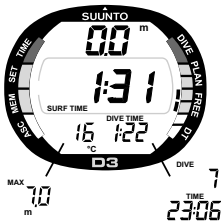
Fig. 3.14. Visualización después de una apnea. En la pantalla central se indica el tiempo de intervalo en superficie.
