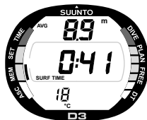
Fig. 5.5. Diario de buceo, página III. Tiempo de intervalo en superficie, profundidad media.
