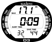
Fig. 3.21. Visualización en superficie. La inmersión anterior ha durado 44 min., con una profundidad máxima de 17,1 m. [56 pies].
