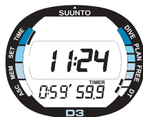
Fig. 2.9. Le compte à rebours commence à partir d'un temps pré-sélectionné et l'indicateur DT clignote.
