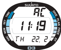
Fig. 2.3. L'activation des contacts humides est indiquée par la mention AC.
