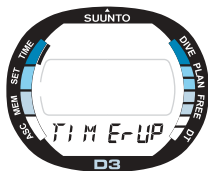
Fig. 2.6. La fonction chrono est indiquée par la mention TIMER UP et un indicateur de temps.
