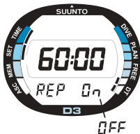
Fig. 4.9. Le compte à rebours et l'alarme de répétition sont sélectionnés.
