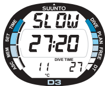
Fig. 3.20. Indicateur de vitesse de remontée. La mention SLOW clignote, quatre segments s'affichent et l'alarme sonore se déclenche. La vitesse de remontée est supérieur à 10 m/min.
