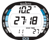
Fig. 3.18. L'affichage en plongée. Profondeur réelle 10,2m, temps de plongée 27 min et 18 sec, température et temps de plongée sont indiqués au bas de l'écran.
