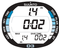
Fig. 3.11. Apnée. La profondeur réelle est de 1,4m et le temps de plongée est de 2 secondes.
