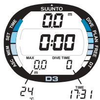
Fig. 3.5. Départ III. Mode Plongée. Profondeur et temps de plongée sont à zéro. Appuyez sur +/- active l'affichage alterné de la profondeur maxi et du temps réel.
