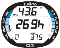
Fig. 5.9. Mémoire Historique d'une plongée. Nombre total de plongées, nombre d'heures et profondeur maximum.
