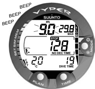
Fig. 3.13. Indicateur de vitesse de remontée. Profondeur instantanée clignotante, mention SLOW et quatre segments affichés : la vitesse de remontée est supérieure à 10 m/min. Il faut ralentir. Le signal STOP signifie qu'un palier de sécurité obligatoire doit être effectué lorsque la profondeur de 6 m est
