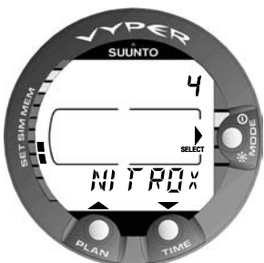
Fig. 4.31. Les réglages oxygène de l'utilisation nitrox [4 NITROX].
