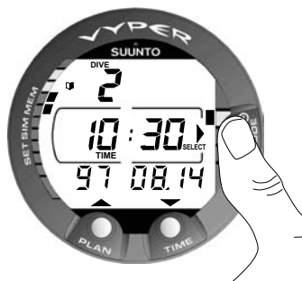
Fig. 4.11. Carnet de plongée, page I. Une pression sur le bouton MODE (SELECT) permet de basculer sur le défilement des différentes plongées.
