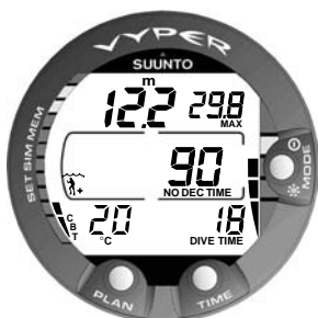
Fig. 3.11. Indicateur de vitesse de remontée. Trois segments.
