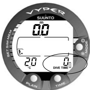
Fig. 3.5. Alarme Pile. Le voyant en forme de pile indique que la pile est trop faible et qu'il est recommandé de la remplacer.
