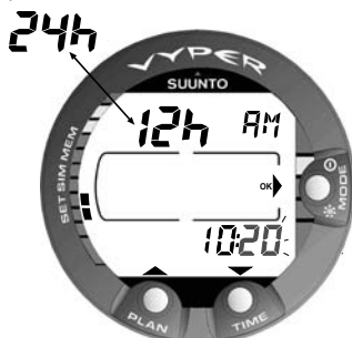
Fig. 4.35. Réglage du format et de l'heure.
