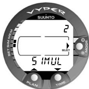
Fig. 4.3. Accès au mode Simulation [2 SIMUL].
