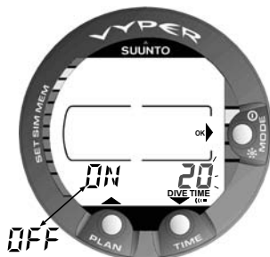
Fig. 4.28. Réglage de l'alarme de temps de plongée. Utiliser les boutons de défilement pour mettre l'alarme sur ON ou OFF et régler le moment de son déclenchement.
