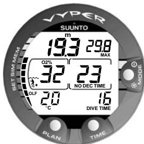
Fig. 3.22. En plongée au nitrox. Réglage O 2 % sur 32%.
