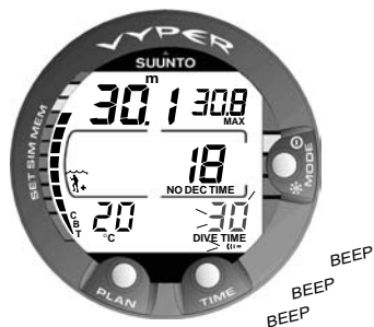
Fig. 3.32. L'alarme de temps de plongée est activée.
