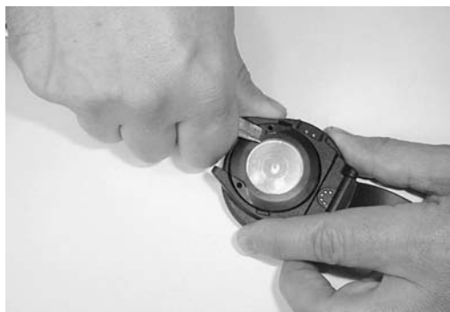
Fig. 5.2. Ouverture de la bague de verrouillage.
