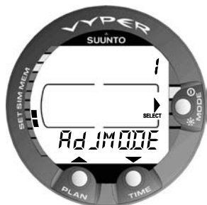
Fig. 4.24. Réglage d'altitude et réglage personnalisé [1 AdJ MODE].
