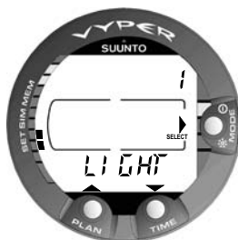
Fig. 4.41. Les réglages de l'éclairage [1 LIGHT].
