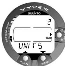
Fig. 4.43. Réglage du type d'utilisation.
