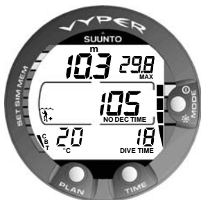
Fig. 3.12. Indicateur de vitesse de remontée. Quatre segments.
