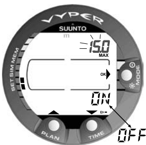
Fig. 4.30. Réglage de l'alarme de profondeur maximum. Utiliser les boutons de défilement pour mettre l'alarme sur ON ou OFF et régler la profondeur de déclenchement.
