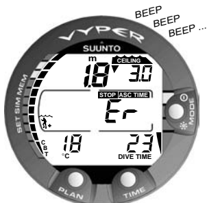
Fig. 3.19. Plongée avec décompression, au-dessus de la profondeur plafond.
