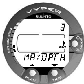
Fig. 4.29. Alarme de profondeur maximum [3 MAX DPTH].
