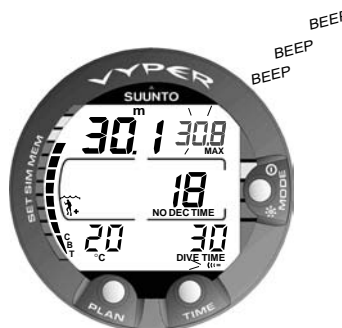
Fig. 3.33. L'alarme de profondeur maximum est activée.
