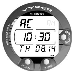
Fig. 2.4. L'abréviation AC indique que les contacts humides sont actifs.
