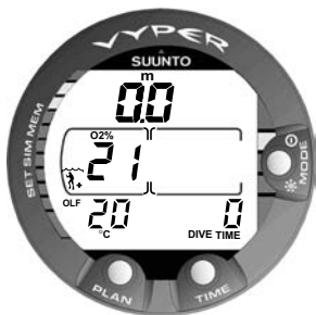
Fig. 3.21. Affichage surface en utilisation ordinateur NITROX.
